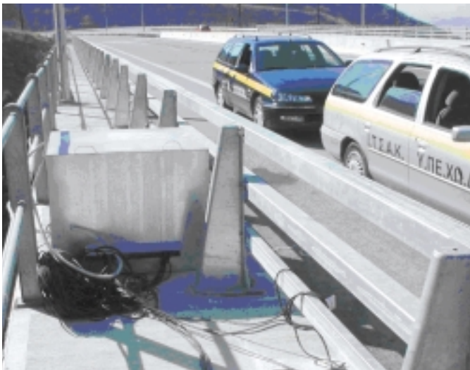
Χαραδρογέφυρα της ΚΑΒΑΛΑΣ στην οποία χρησιμοποιήθηκε το κινητό σύστημα μέτρησης της απόκρισης της γέφυρας.
